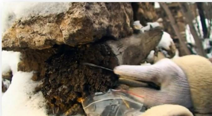
Рис.13.4. Кадр из фильма. Взятие образцов древесины на анализ из обнажений деревянного каркаса здания
